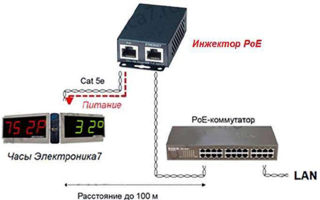
**Синхронизация с точным временем с использованием NTP протокола и питания PoE с помощью PoE инжектора**
