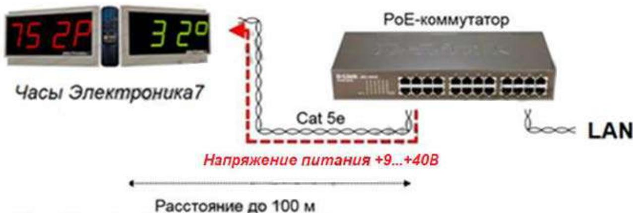
**Синхронизация с точным временем с использованием NTP протокола и питания PoE**
